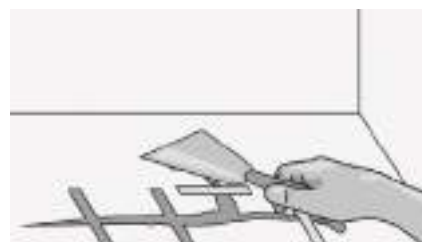
Рис. 6. Убрать выступающую на поверхность смолу
