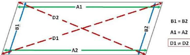
Рис. 14. Измерения потолка
