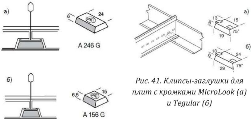
Рис. 41. Клипсы-заглушки для плит с кромками MicroLook (а) и Tegular (б)
