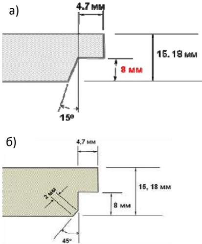
Рис. 5. Типы кромок плит
