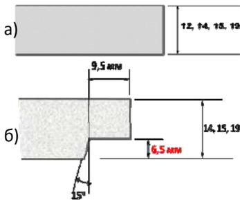
Рис. 4. Типы кромок плит
