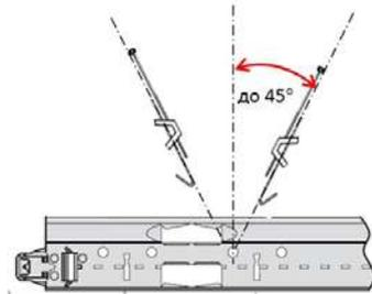
Рис. 36. Расположение подвесов вдоль оси несущей рейки
