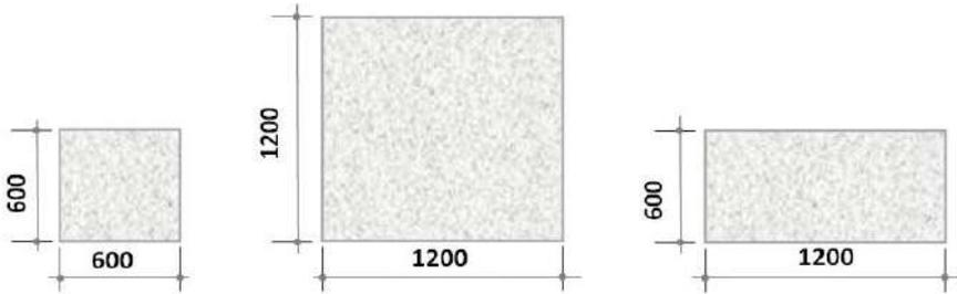
Рис.. 2. Плиты (панели)
