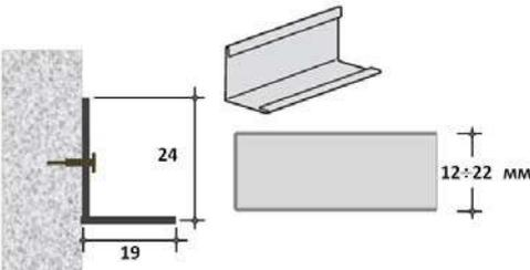
Рис. 9. L-образный молдинг рекомендован для использования с потолочными панелями с кромкой Board
