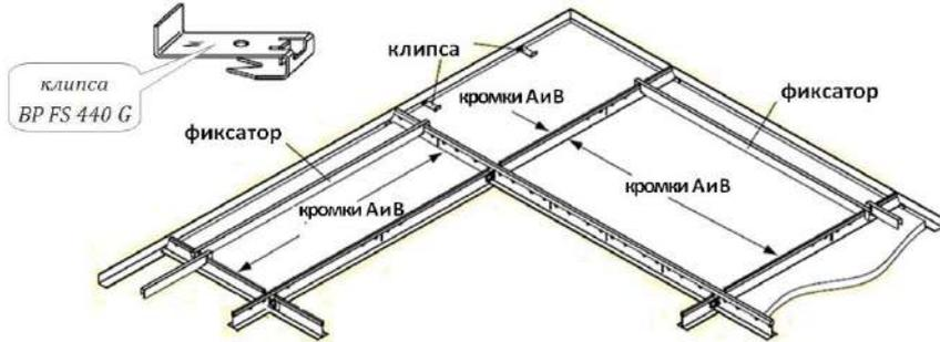
Рис. 54. Монтажная схема потолка – вариант с L-образным молдингом
