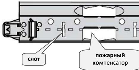
Рис. 8. Слот, пожарный компенсатор на несущей рейке
