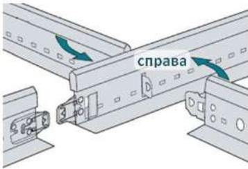
Рис. 46. Установка поперечных реек в несущую рейку
