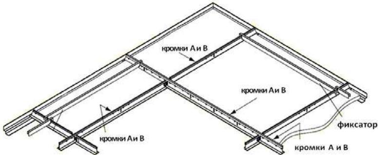
Рис. 56. Монтажная схема потолка – вариант со ступенчатым молдингом
