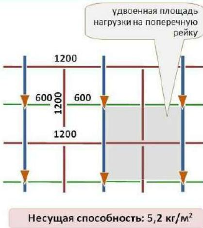
Рис.18. Перегруженная схема
