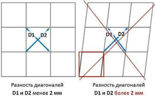
*Рис. 34. Разность диагоналей в ячейках подвесной системы*
