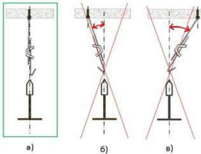
Рис. 35. Расположение подвесов относительно осевой линии несущей рейки
